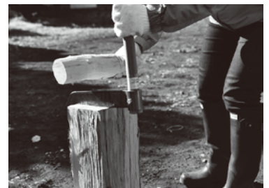
万力と木槌を使ってイスの脚部分を切り出していく
